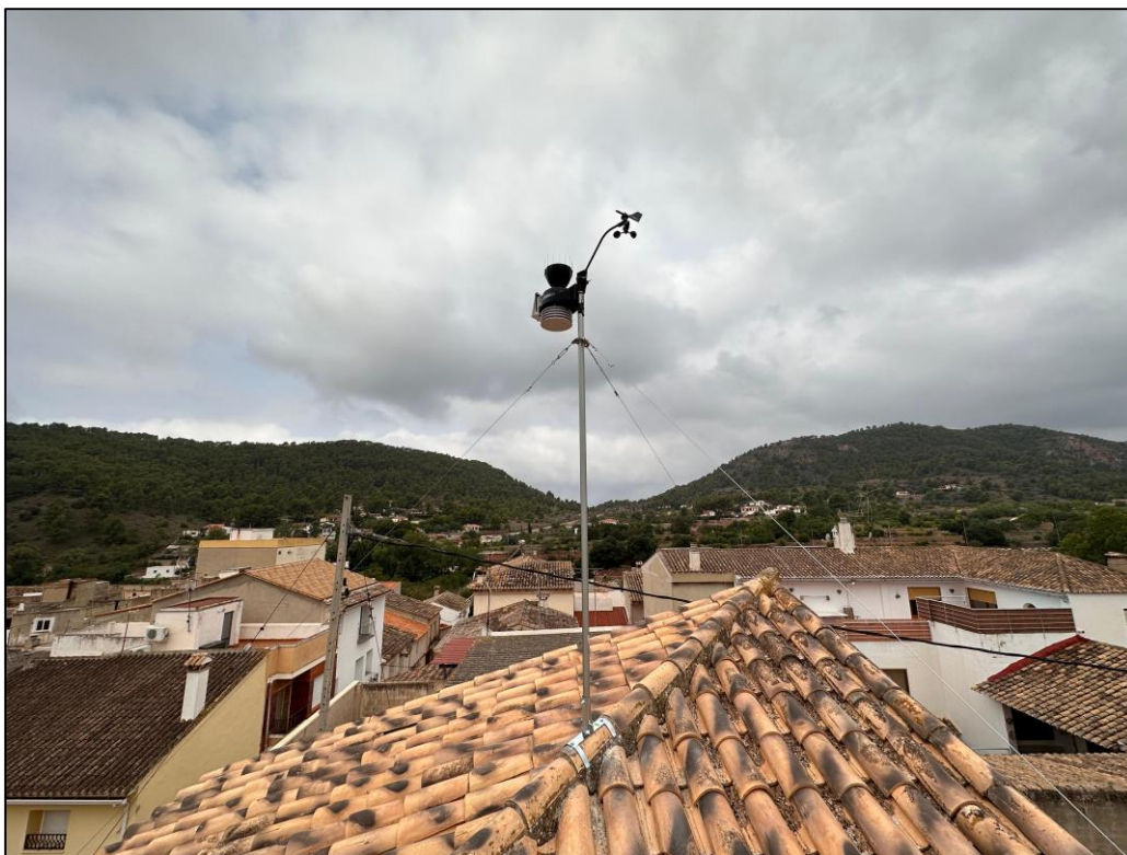
Figura 1. Estación meteorológica Davis Vantage Pro2 de Olocau.
